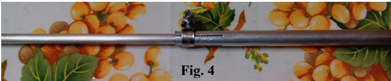
Anche in questo caso abbiamo usato due dadi da 10mm (uno sopra l'angolare, a battuta con la filettatura del bullone *scapocciato* ed uno sotto), si è regolato lo scorrimento dei due tubetti, per avere una lunghezza dell'elemento, a partire dalla battuta superiore dell'angolare di 1465mm (la giunzione dei due tubetti è stata segnata con un seghetto, così da ritrovarla velocemente in fase di montaggio).
